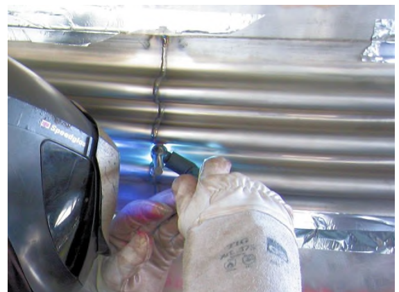
Lassen van langsnaad van clam shell
