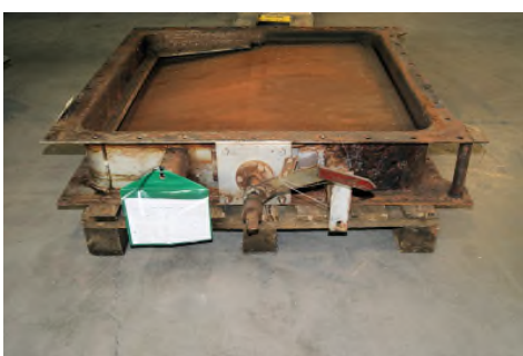
Rookgaskleppen compleet uitgebouwd
