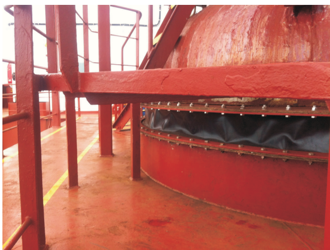
Tankdome Aramide versterkte compensator na vervanging
